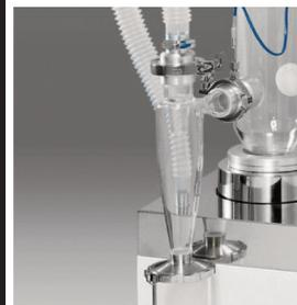
干燥腔、旋风分离器、生成物捕集容器的拆卸或清洗采用的是快插方式，可以很方便的进行。
