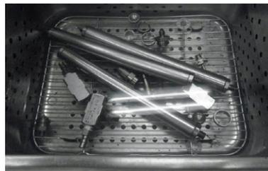
建议使用超声波清洗机清洗精细喷嘴等部件。
