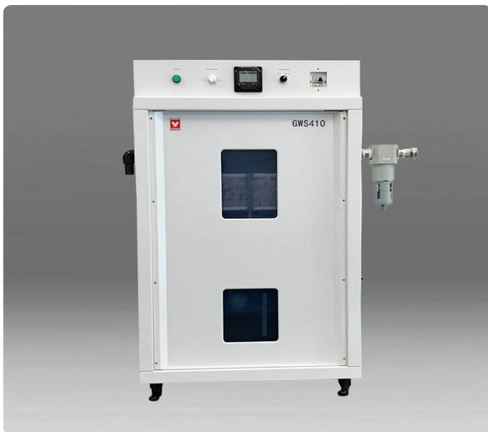
GWS410 通过使用常压和室温下的清水或碱性溶液来捕集有害气体中的污染物。GWS410 设计有一个清洗槽——当溶剂蒸汽进入清洗槽时，喷淋的水附着、清洁并中和溶剂粒子，然后返回槽底。
